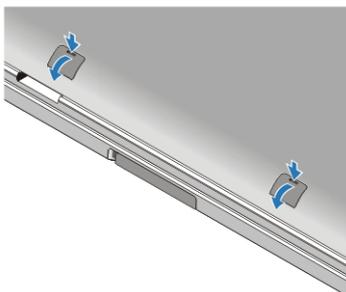
2. Placez la poignée dans les emplacements. Utilisez les vis pour serrer et sécuriser la poignée et l'ordinateur.
